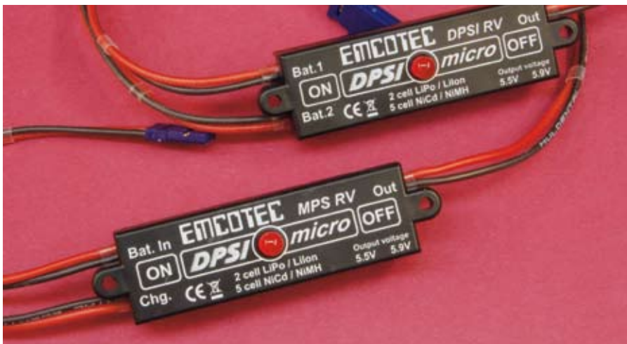
DPSI RV micro und MPS RV micro unterscheiden sich lediglich durch die unterschiedliche Eingangsbelegung. Werden bei dem DPSI die beiden Akkus angeschlossen, dient bei dem MPS der zweite Eingang als Ladebuchse
