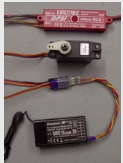
▲ Zum Parallelschalten von Servo und Schalter bietet Emcotec passende V-Kabel an. Man kann einen Mischer und einen Kanal sparen, weil die RCS-Schalter programmierbar sind.
