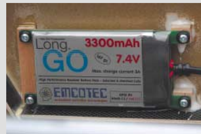
Oben ein Blick auf die Art und Weise der Spannungsauswahl; rechts ist die professionell wirkende Art der Akku-Befestigung im Modell zu sehen.
